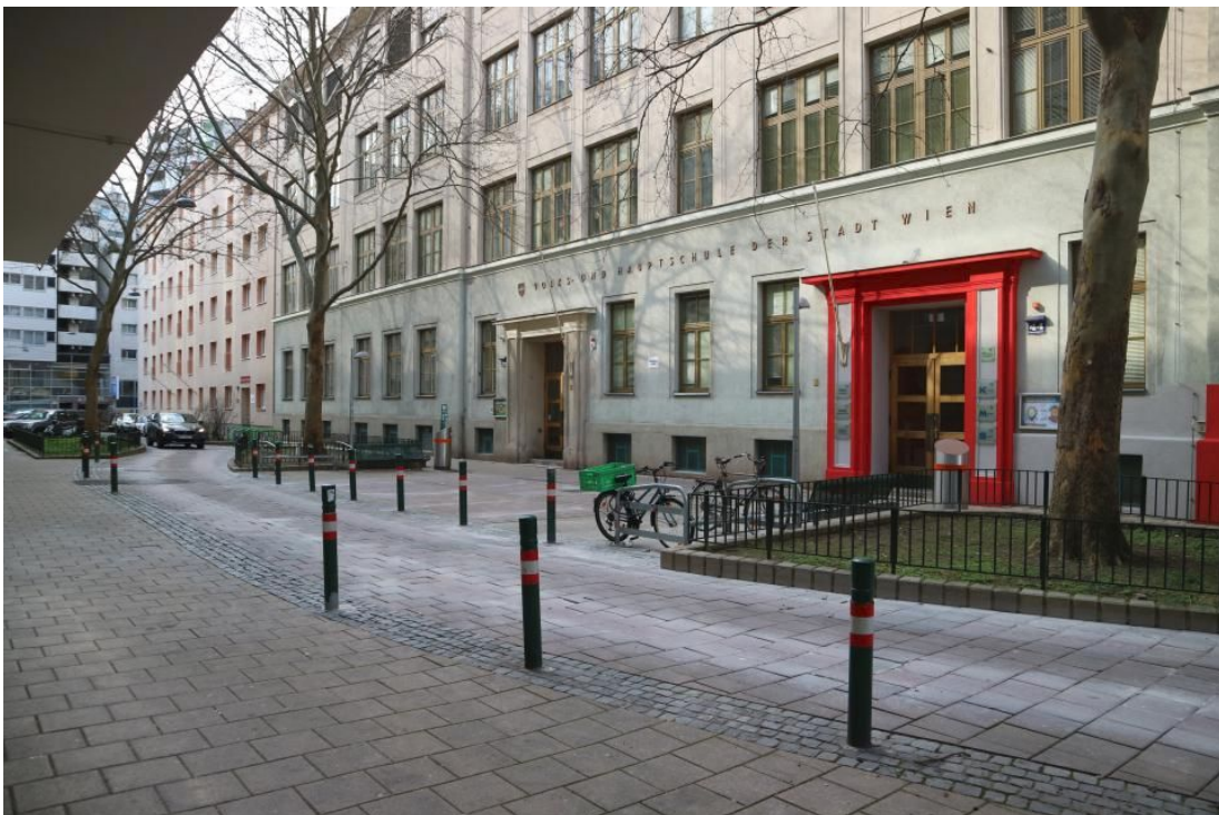
Positivbeispiel Schulvorplatz: als Wohnstraße ausgeführt mit Aufpflasterung, verschwenkter Fahrbahn, Bäumen, Sitzgelegenheiten und Radabstellanlagen, Gassergasse (5.) (Quelle: Barbara Laa)
